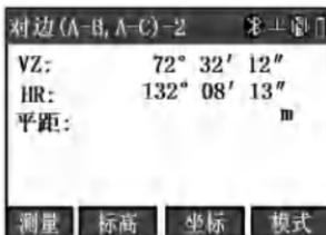
3) 使用与第一步中同样的方式得到坐标; 按[ENT]键确认后进入“对边(A-B,A-C)-结果”窗口:
