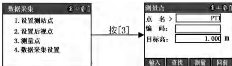
2) 按[F1] (输入) 键, 输入待测点点名, [确认], 输入编码:
