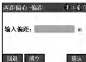
输入偏距，按[确认]键后出现“两距偏心-起点”窗口，该点要瞄准 P0 点进行测距，测距完成后按[ENT]按键结束窗口，进入“两距偏心-终点”窗口，如图所示：
