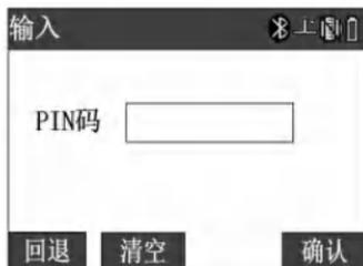
输入 PIN 码（82543）之后按[确认]键，仪器关机；
