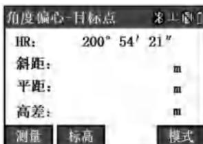
目标点是指放置棱镜的点，如果需要重新输入目标高，可以按[标高]键，重新输入标高，按[测量]键启动测量，测量前是修改标高的机会，测量完成后，出现[确认]键，按[确认]键进入“角度偏心-偏心点”窗口：
