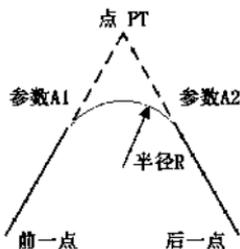
输入数据时软件强制半径 R、A1 和 A2 不能为负数。若输入半径，则会在当前点和下一点之间插入指定半径的弧。A1、A2 为缓和曲线的弧线长度。
