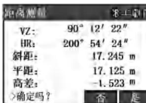
7) 系统将自动将点名+1，开始下一点的测量。可按上述方式输入目标点名、编码、目标高并照准该点。可按[F4]（同前）键，按照上一个点的测量方式进行测量；也可按[F4]（测量）选择测量方式。
