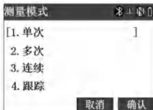
按[▲][▼]键移动“[]”指针到所要求的选项，按[确认]键接受选择，并将设置保存到系统文件。仪器以后开机后的默认测距模式既是所选择的模式。其他所有设置的操作和用途都与测距模式设置相似，这里不再
