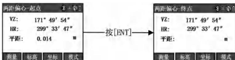
瞄准终点，测量完成后，按[ENT]键进行确认。此时仪器将显示待测点的坐标，如图所示：
