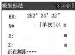
4)测量结束，显示测得的坐标值，按[F4]（是）键记录。点名与坐标值存入坐标数据文件显示下一个新点输入菜单，点名自动加1。
