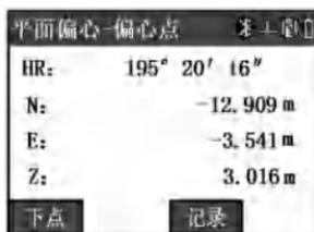
转动仪器照准偏心点——请注意此时偏心点一定是平面上的点而不能是棱镜杆下的点，否则结果不正确。照准后即可得到偏心点的坐标。在瞄准过程中，坐标值一直在刷新。按[下点]键时进入下一平面的偏心测量；按[记录]键记录偏心点坐标；按[ESC]键退出平面偏心测量。
