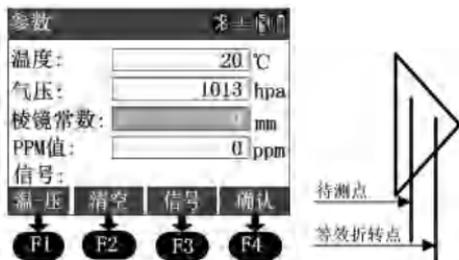
一般进入后，插入符默认停在棱镜常数的参数栏中，如果不是此种情况，请按[确认]或[▲][▼]按键将插入符移到棱镜常数的输入框直接输入。通常棱镜转动中心标示的点是待测量点，而测量光线进入棱镜的等效折转点并不在此点上（如上图所示），设此二者的差值为30mm，而折转点在待测点的后面，此时应设置棱镜常数为-30，反之棱镜常数应设置为+30。市面上目前流行的棱镜有-30或0两种，请使用时加以区分。
